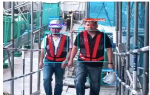
說明:偵測到未確實配戴個人防護具，蜂鳴器將持續鳴響
