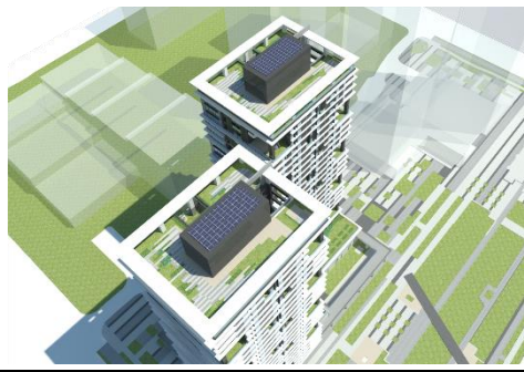
說明:建置太陽能發電系統
